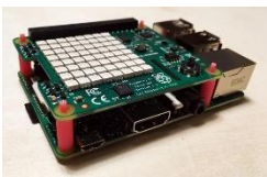
SenseHAT ・8×8、16ビットLEDディスプレイ ・慣性測定ユニット(IMU): 加速度、ジャイロ、磁カ) ・気圧センサ ・温度センサ ・湿度センサ ・4方向+1方向ジョイスティック(上下左右+押し込み)
